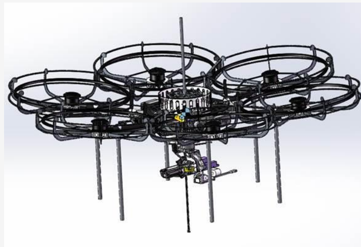
图6 无人机的solidwork模型
